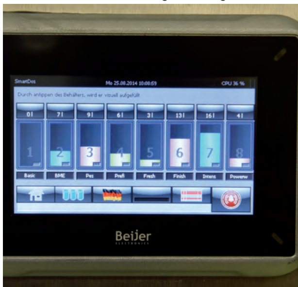
Das benutzerfreundliche LED-Display gibt Auskunft über die Füllstände. Auch Detailauswertungen sind möglich.
